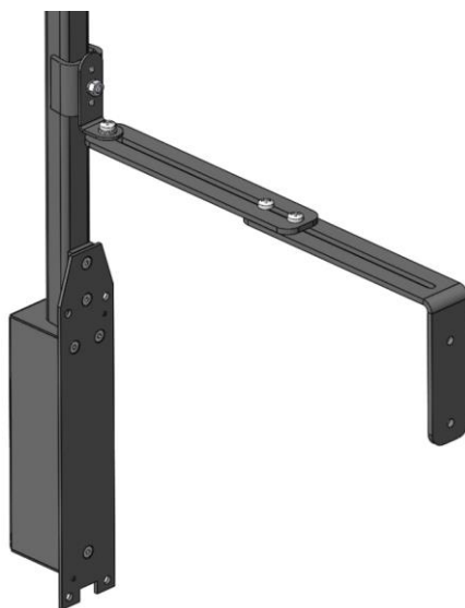
Рисунок 1.5 - Крепление кронштейна к блоку извещателя
